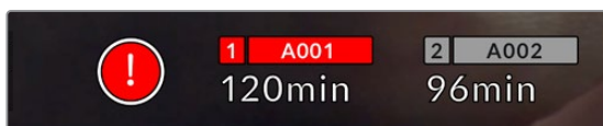
CFast 카드 1에 발생한 드롭 프레임 현상을 알리는 드롭 프레임 경고 표시
