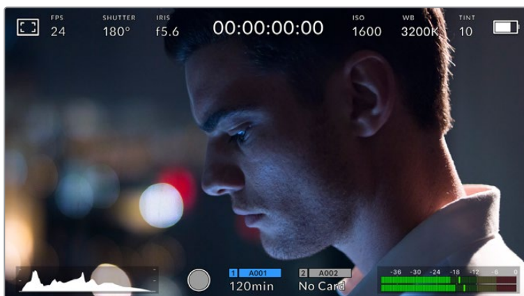
Der LCD-Touchscreen Ihrer URSA Mini verfügt über ein umfassendes Head-up-Display und bietet Zugriff auf die am häufigsten verwendeten Kameraeinstellungen
