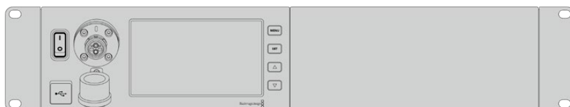
Il pannello di copertura chiude lo spazio inutilizzato sul rack
