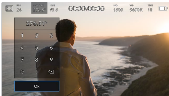
シャッターキーパッドで、任意のシャッターの値をマニュアル入力
