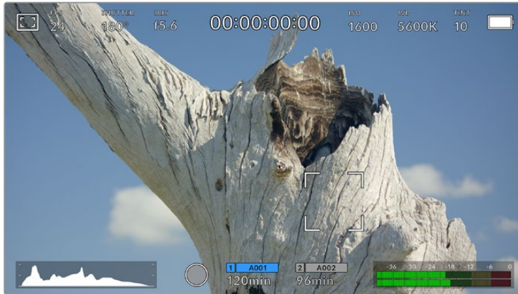
タッチフォーカスが表示されたURSA MiniのLCDタッチスクリーン
